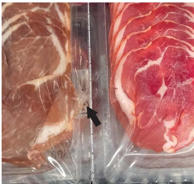
Imagen 60. Presencia de producto en la zona de soldadura del material de envasado.
